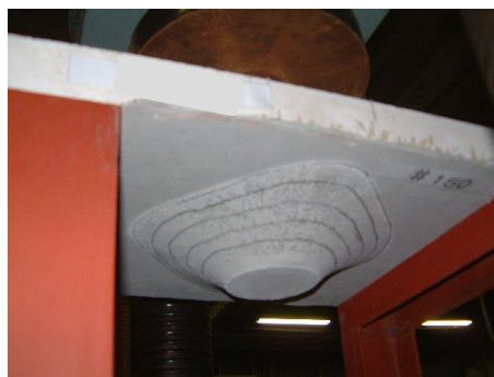
押抜き試験の状況
