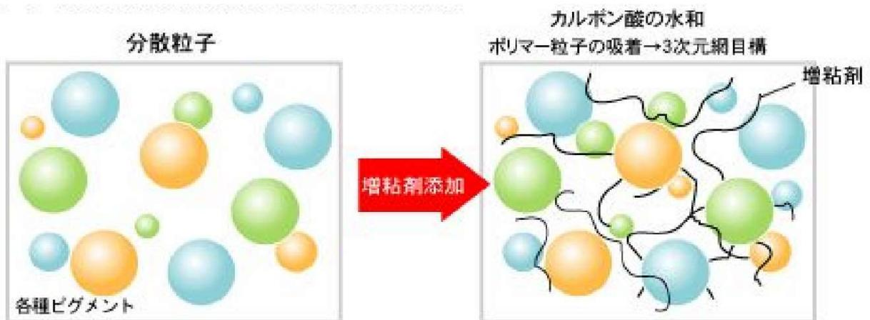
増粘のメカニズムは、カルボキシル基と水分子との水素結合形成、いわゆるカルボン酸部分の水和と、増粘剤ポリマーがピグメント粒子に吸着することで形成される3次元網目構造体による構造粘性の付与で説明されています。
