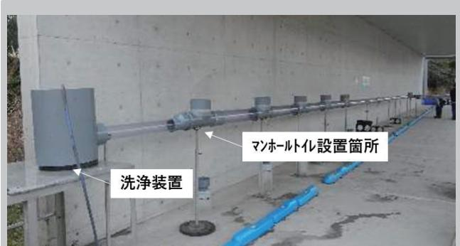
図3 実機試験状況
