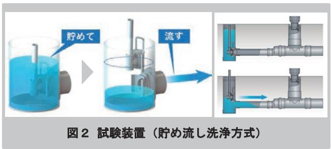
図2 試験装置(貯め流し洗浄方式)
