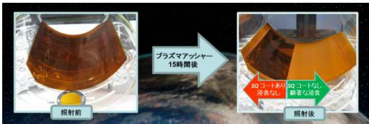
写真2 ポリイミドフィルムに対するプラズマアッシャー試験 (簡易的耐 AO 試験)
